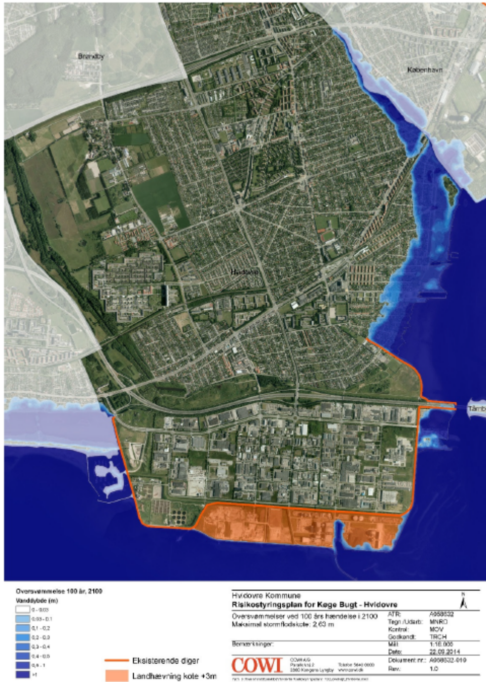
Figur 15 Kortet viser oversvømmelser fra stormflod i Hvidovre Kommune (risikoområdet) ved en 100-årshændelse i 2100, samt eksisterende diger og hævet landområde sydligst på Avedøre Holme. Kortet er fra Risikostyringsplan 2015.
